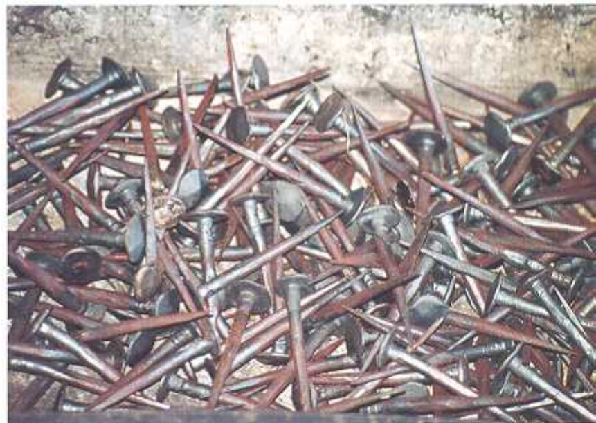
Pour cintrer les clins, on les a d'abord fixés à l'aide de boulons et écrous qui sont ensuite progressivement remplacés par les pièces forgées, au fur et à mesure de leur fabrication.
