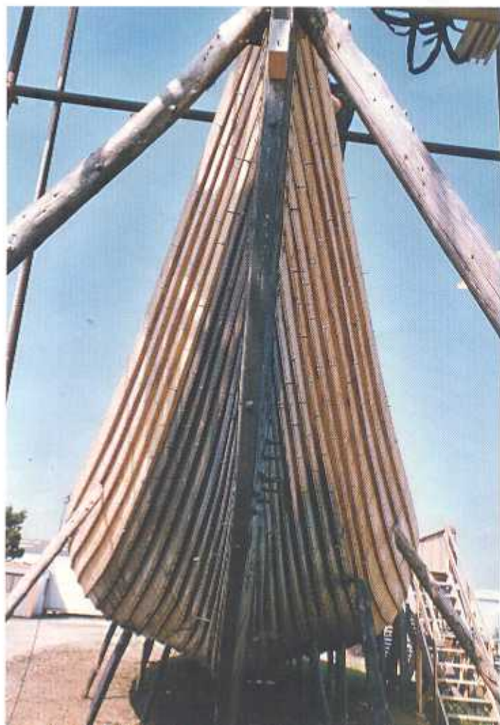
Ci-dessus : comme sur tous les bateaux vikings, la poupe est aussi effilée que la proue ; une caractéristique qui facilite les changements de direction lors de la navigation à la rame.
