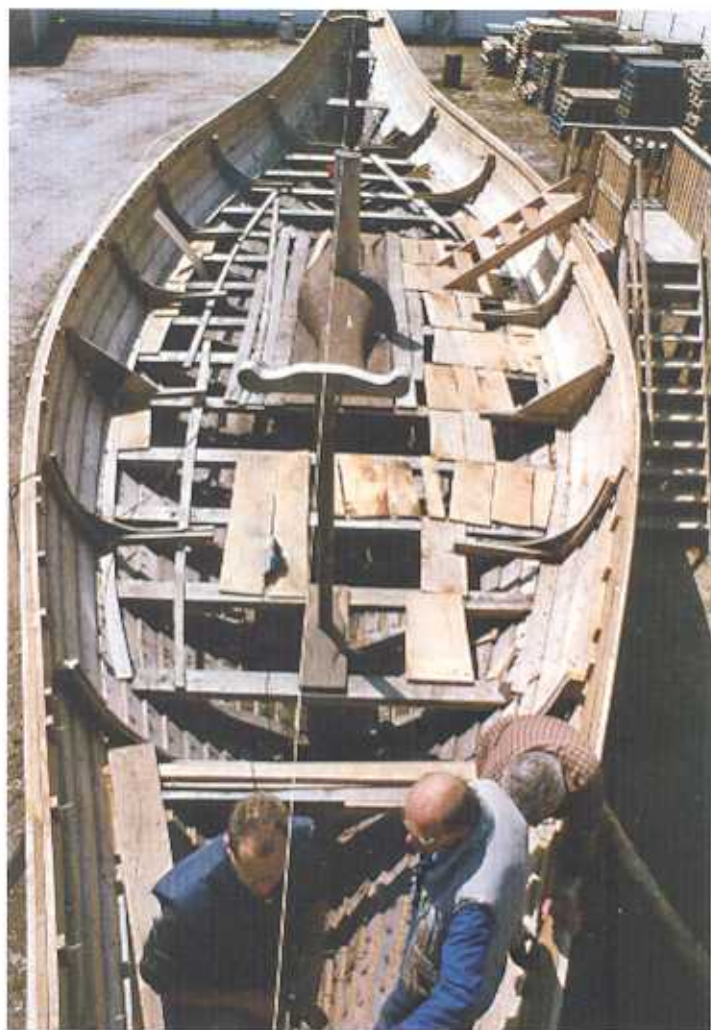
Ci-dessus : comme sur tous les bateaux vikings, la poupe est aussi effilée que la proue ; une caractéristique qui facilite les changements de direction lors de la navigation à la rame.
