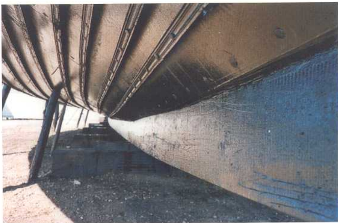
3. Sous la coque goudronnée, la quille en chêne est faite d'un seul tenant.
